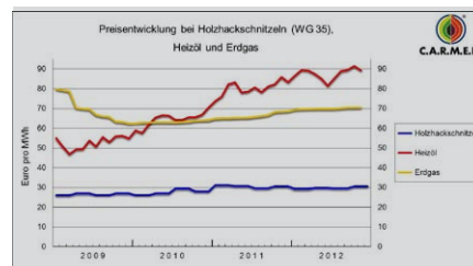
Vergleich auf Basis des Preises für Holz hackschnitzel aus Forstbeständen. Hackschnitzel aus Plantagenholz können preislich geringfügig vom dargestellten Kostenverlauf abweichen. Quelle: Centrales Agrar-Rohstoff-Marketing- und Entwicklungs-Netzwerk e.V., www.carmen-ev.de , Stand Juni 2012
